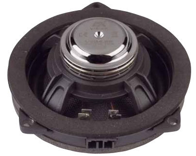
Edle Alu-Druckgusskörbe und Neodymantriebe finden sich beim Türlautsprecher genauso wie beim Untersitzwoofer
