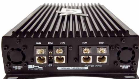
Doppelte Stromklemmen bei der VX8000 PRO (links), einfache bei den anderen (rechts). Die Bedienfronten haben zwei Mono-Niederpegelanschlüsse, einen bis 3,6 Volt und einen DSP-Anschluss bis 9 Volt
