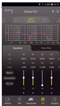
Wie hier der Ausgangs-EQ werden auch Eingangs-EQ und Staging-EQ eingestellt
