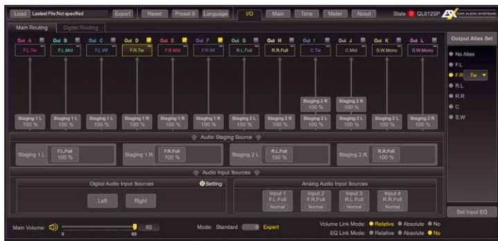
Im Expertenmodus kommt zwischen Eingänge und Ausgänge eine neue Staging-Ebene mit eigenem EQ
