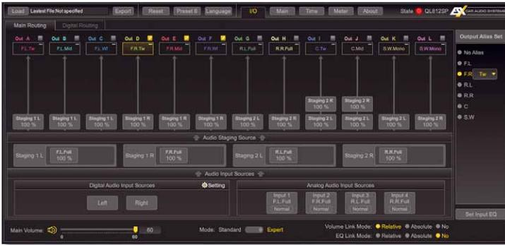
Im Expertenmodus kommt zwischen Eingänge und Ausgänge eine neue Staging-Ebene mit eigenem EQ
