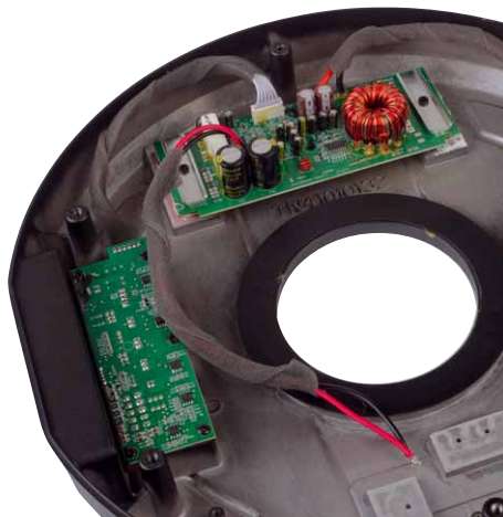
Oben die Endstufenplatine mit einer klassischen Class-AB Schaltung und Trafonetzteil
