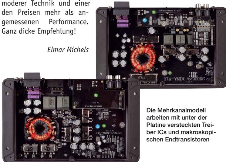
Die Mehrkanalmodell arbeiten mit unter der Platine versteckten Treiber ICs und makroskopischen Endtransistoren
