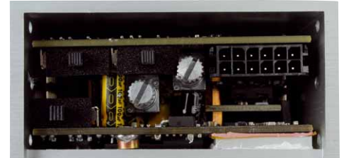
Eine Aluminium-Kontaktplatte sorgt für Kühlung der Verstärkung
