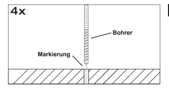
Legen Sie dann den Prozessor beiseite und bohren dann die Löcher für die Fixierschrauben an den zuvor markierten Punkten. Vergewissern Sie sich zuvor, dass keine Kabel, Leitungen und andere Komponenten des Fahrzeugs beim Bohren beschädigt werden. Alternativ können Sie auch (je nach Untergrund) selbstschneidende Gewindeschrauben verwenden.
