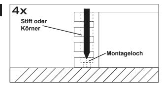
Belassen Sie dann den Prozessor an der gewünschten Einbaustelle im Fahrzeug. Markieren Sie die vier Bohrlöcher durch das jeweilige Montageloch an den Gussendteilen mit einem geeigneten Stift oder Körner.
