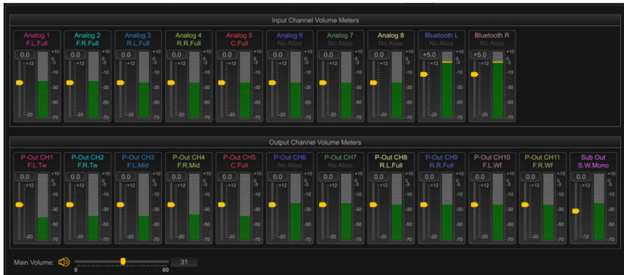
Der **grüne Bereich** zeigt an, dass der Pegel optimal eingestellt ist, ohne dass Anpassungen erforderlich sind. Mit dem gelben, seitlich angeordneten Schieberegler kannst du den Pegel jedes Kanals individuell um bis zu +12 dB anheben oder um bis zu -20 dB absenken.
