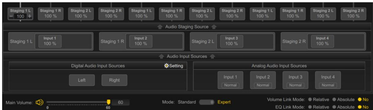
Im Expert Mode erfolgt die Zuordnung der Eingangskanäle zu den Ausgangskanälen in zwei Schritten. Zunächst werden die analogen und digitalen Eingangssignale den vier Staging Kanälen zugeordnet. Anschließend werden die Staging Kanäle den jeweiligen Ausgangskanälen zugewiesen. Auch im Expert Mode ist es besonders hilfreich, allen Kanälen Aliasnamen zu vergeben, um den Überblick zu bewahren und das Routing zu erleichtern.
